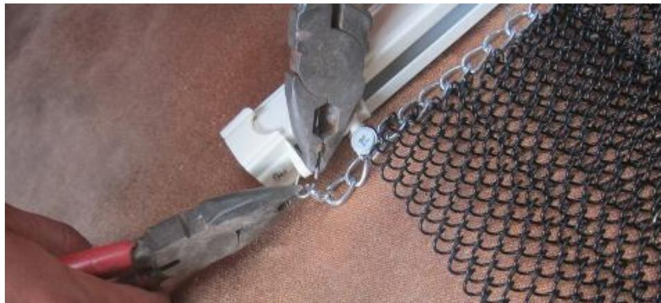
将固定链条安装在轨道封闭件上。
